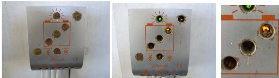
*Régulateurs colonisés par les mouches maçonnes, en cours de nettoyage...*
