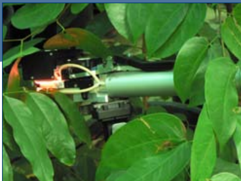
Mesures de l'activité photosynthétique des arbres - © INRA
